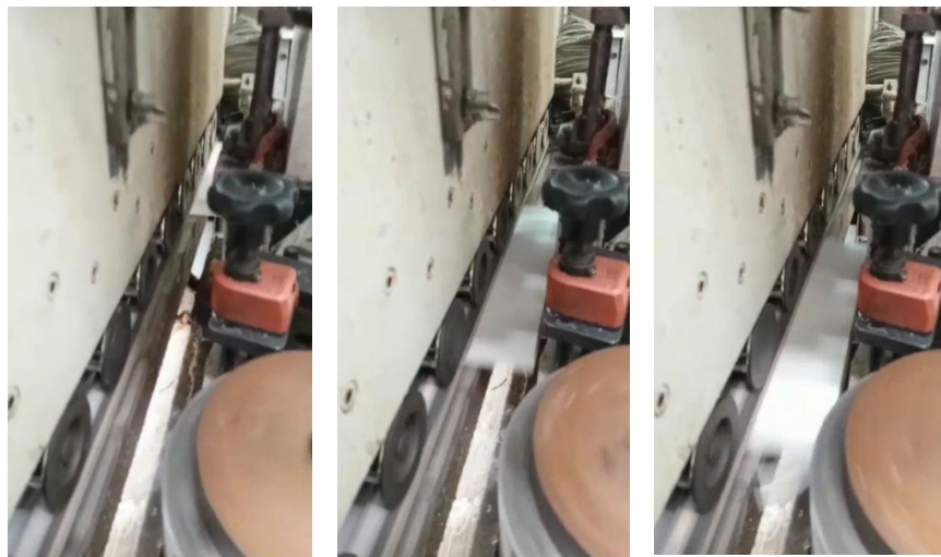
Figura 4 – Processo de colagem de borda na coladeira de borda.
