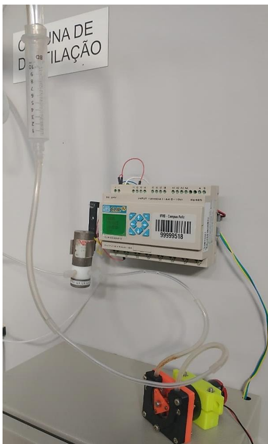
Figura 10. Controlador lógico programável, válvula solenoide e bomba peristáltica utilizados.
