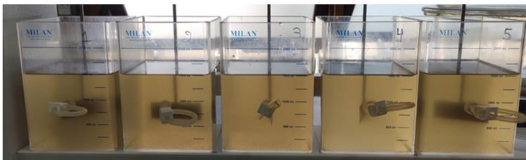
Figura 15 – Resultado do ensaio preliminar 2B na etapa de decantação
