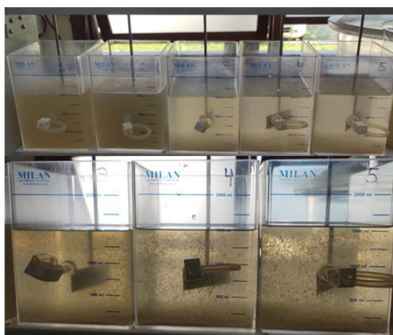
Figura 14 – Resultado da etapa de decantação do ensaio preliminar 2A
