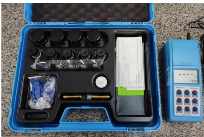
Figura 6 – Equipamento turbidímetro utilizado para medir a turbidez
