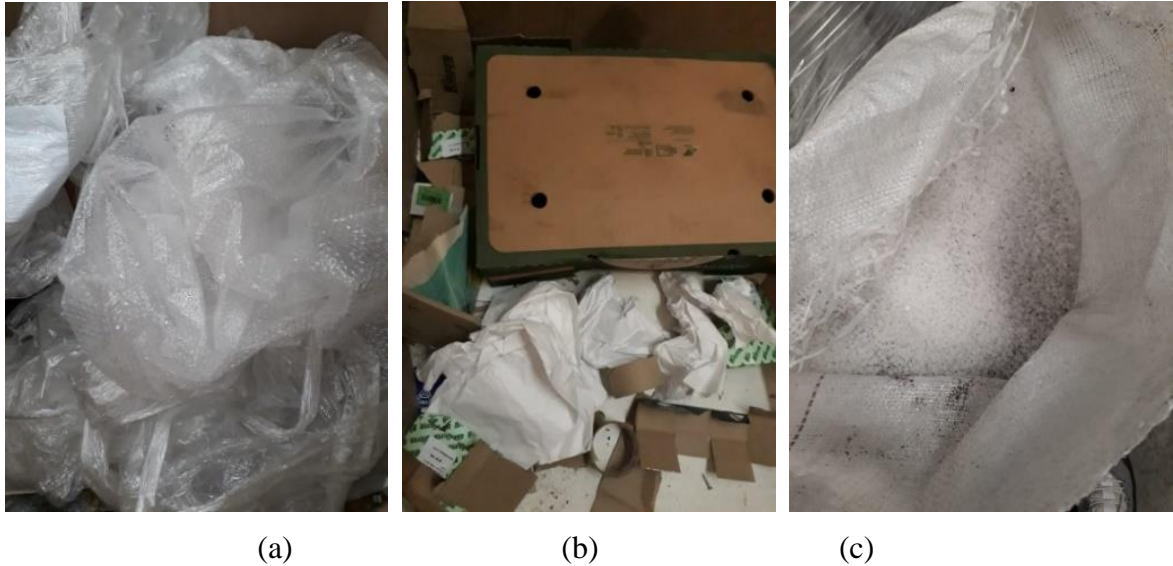
Figura 9: Resíduos da etapa de recebimento de matéria-prima – (a) filmes diversos, (b) papeis diversos e (c) polietileno contaminado.
