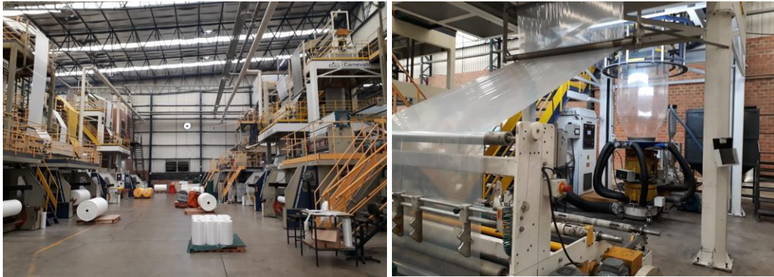
Figura 3: Setor de extrusão – (a) visão geral e (b) extrusora de filme.
