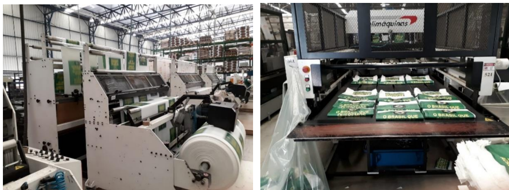
Figura 6: Setor de corte e solda – (a) início do processo e (b) final do processo.
