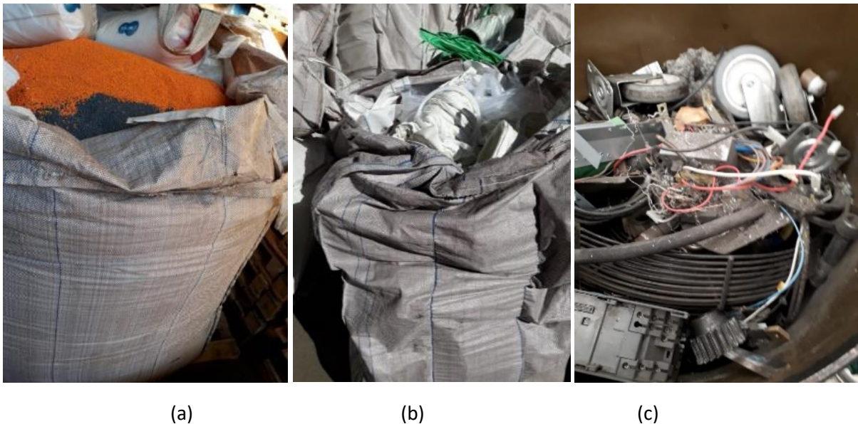
Figura 10: Resíduos da extrusão: (a) pigmento, (b) borras e (c) metais.
