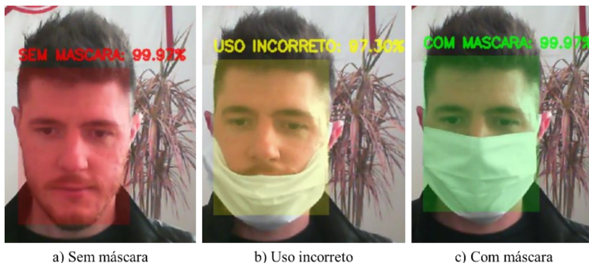
Figura 5. Exemplo de detecção do uso de máscaras em um vídeo de teste: a) pessoa que não está usando máscaras (99.97%); b) detecção de uso incorreto (97.30%); e c) utilização de máscara corretamente (99.97%). Fonte: Elaborada pelos autores.
