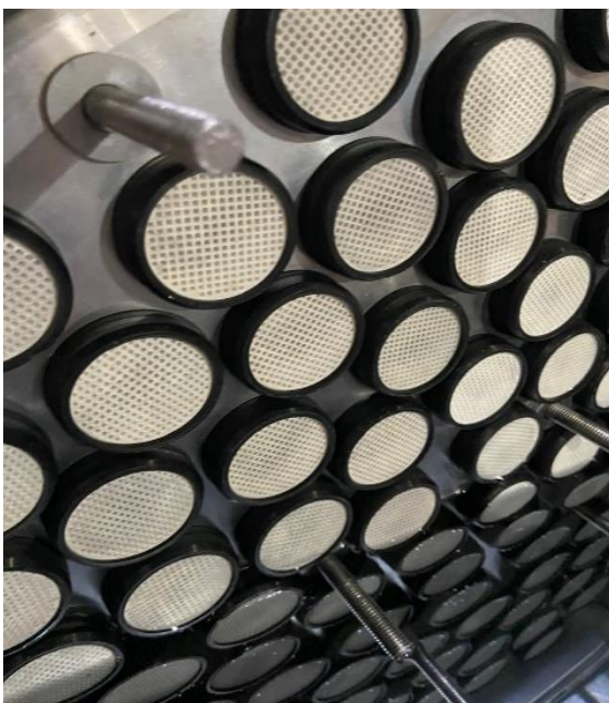
Figura 5: Interior da campana onde ficam localizadas as membranas
