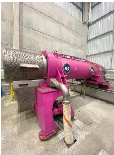
Figura 19, 20 e 21. Esgotador giratório, decanter centrífugo e prensa horizontal contínua.
