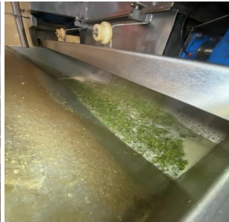
Figura 11 e 12. Desengaçadeira, desengace e esmagamento da uva.
