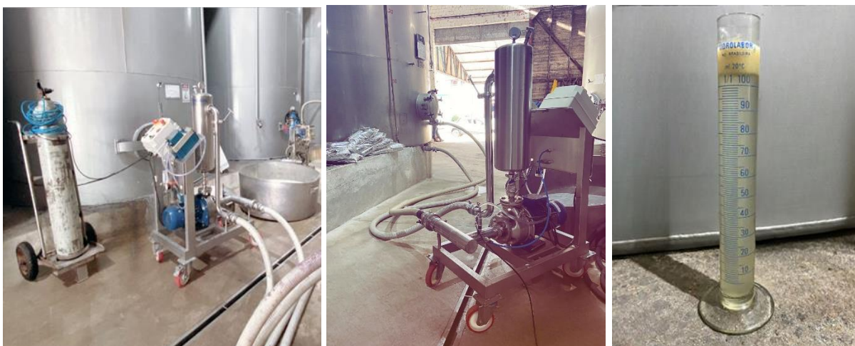
Figura 30, 31 e 32. Unidade de flotação e proveta com mosto flotado.
