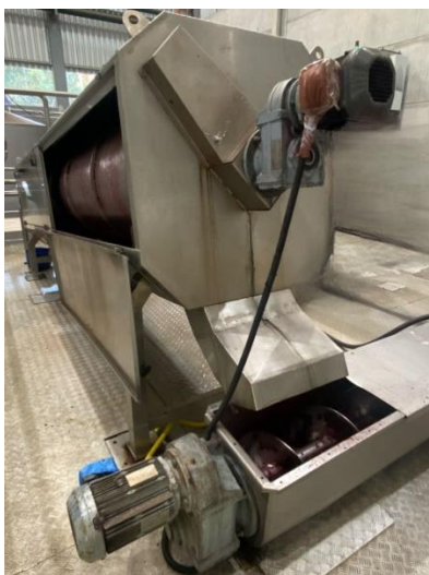
Figura 19, 20 e 21. Esgotador giratório, decanter centrífugo e prensa horizontal contínua.
