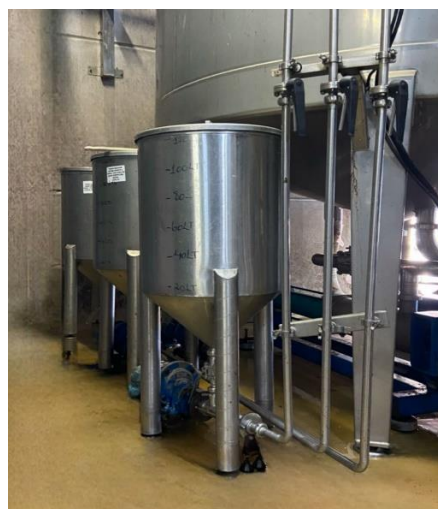
Figura 22 e 23. Tanques pulmão com agitador vertical e tanques dosadores 2.
