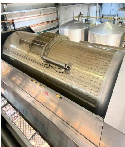
Figura 24, 25 e 26. Prensa pneumática, mosto pelos orifícios do cilindro e mosto prensa na mastela.
