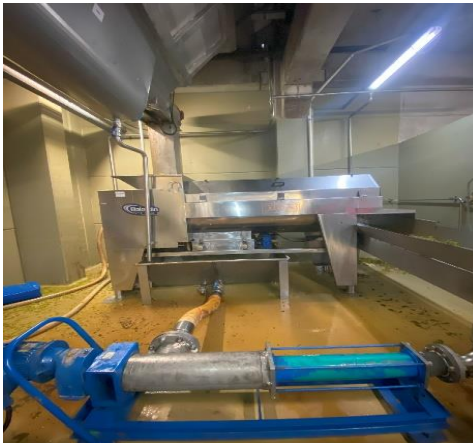
Figura 11 e 12. Desengaçadeira, desengace e esmagamento da uva.
