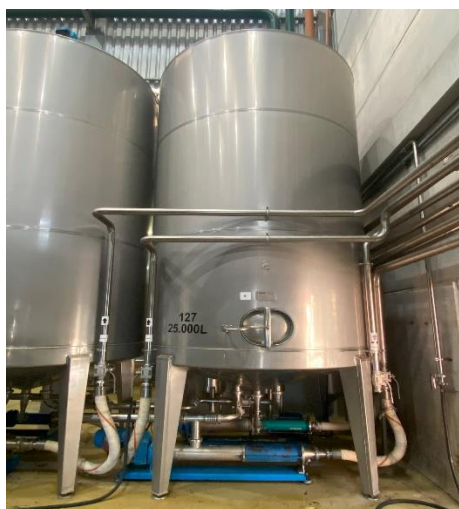
Figura 22 e 23. Tanques pulmão com agitador vertical e tanques dosadores 2.
