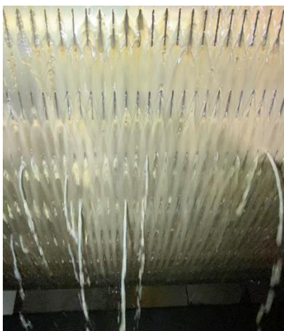
Figura 24, 25 e 26. Prensa pneumática, mosto pelos orifícios do cilindro e mosto prensa na mastela.
