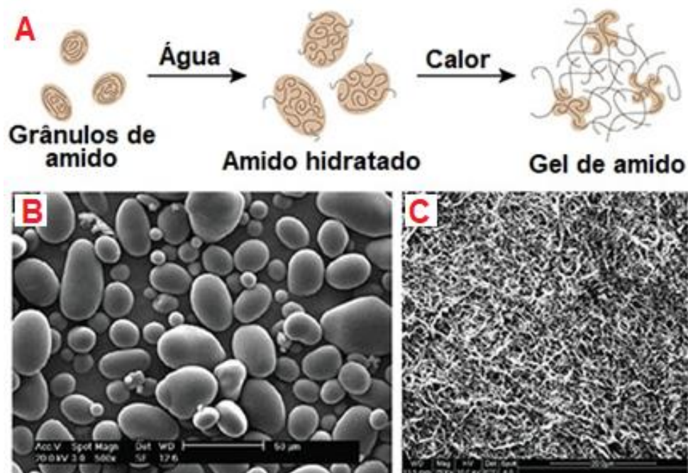
Figura 3 – A: Ilustração do processo de gelatinização; B: MEV da microestrutura do amido nativo; C: MEV da microestrutura do gel de amido.
