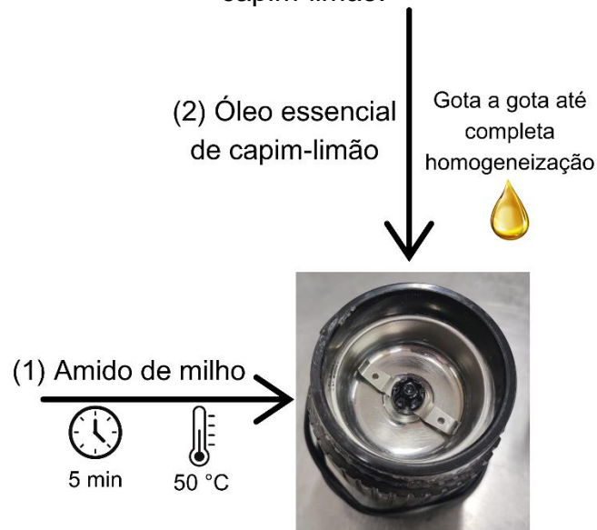
Figura 18 – Fluxograma do processo de incorporação do óleo essencial de capim-limão.
