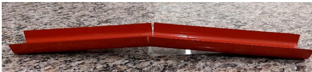
Figura 57 - Deformação e fratura das amostras (1,2,3 e 4).
