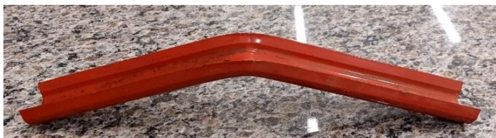
Figura 58 - Deformação e fratura da amostra 5.
