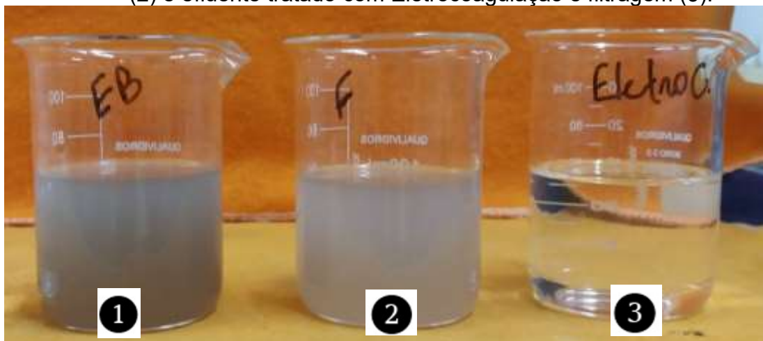
Figura 23 – Comparativo dos resultados entre os diferentes tratamentos de efluentes. Efluente bruto (1), efluente filtrado em filtro de malha de 10 micra (2) e efluente tratado com Eletrocoagulação e filtragem (3).
