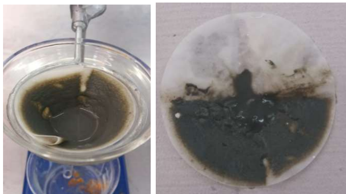
Figura 22 – Lodo proveniente do processo de eletrocoagulação do efluente bruto.
