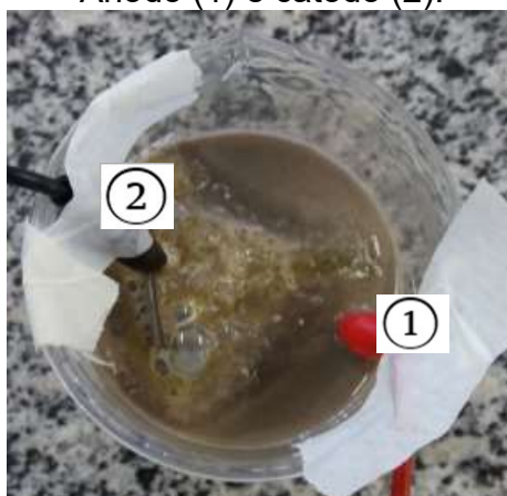
Figura 21 – Fluxo de migração dos elétrons. Ânodo (1) e cátodo (2).
