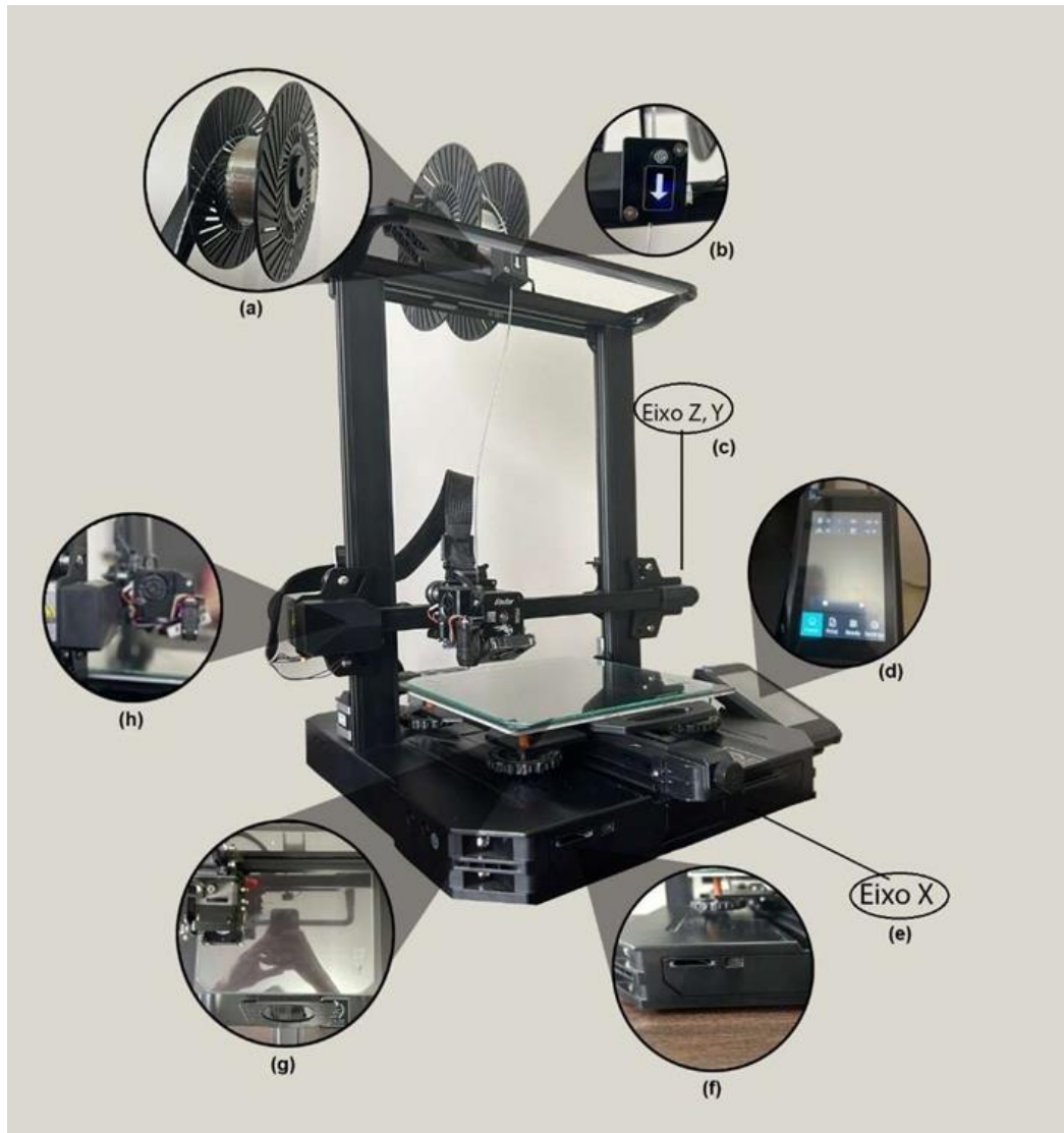
Figura 4 - Representação dos eixos da impressora FDM.
