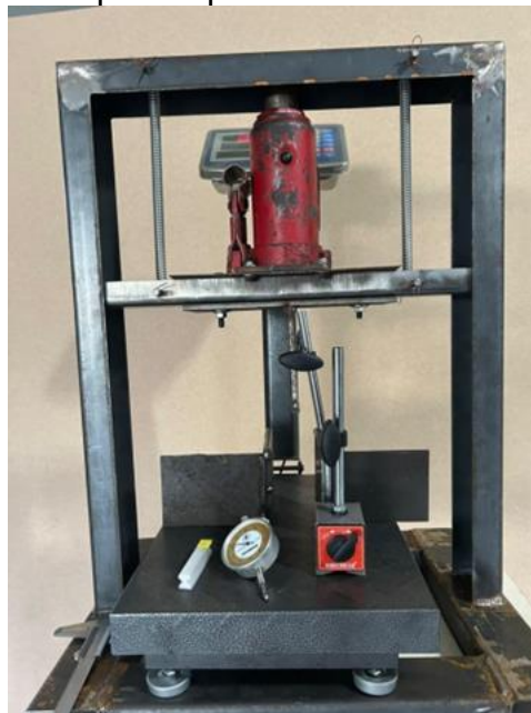
Figura 27 – Aparato para o ensaio de três pontos.
