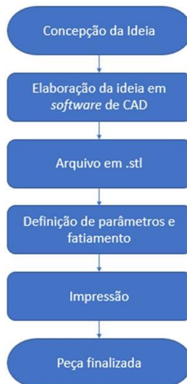
Figura 2– Fluxograma do processo de Impressão 3D.
