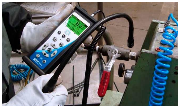
Figura 7 - Medição de ruídos através de um equipamento de ultrassom.
