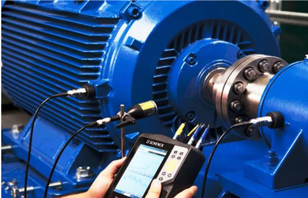
Figura 4 - Análise de vibração em um motor de indução.
