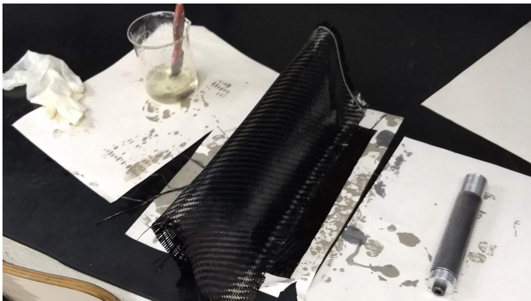
Figura 18 - Laminação da segunda camada de fibra tecido
