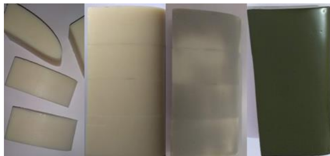
Figura 6. Sequência de produção do macho.
