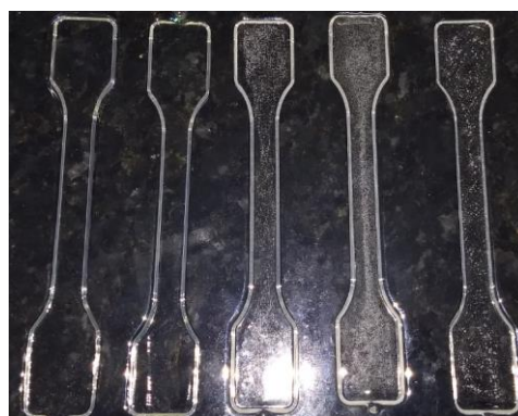
Fig. 3: Processo de extração das bolhas das amostras.
