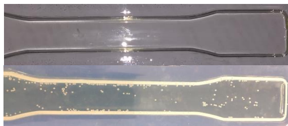
Fig. 7: Corpo de prova D antes e depois do ciclo de cura.
