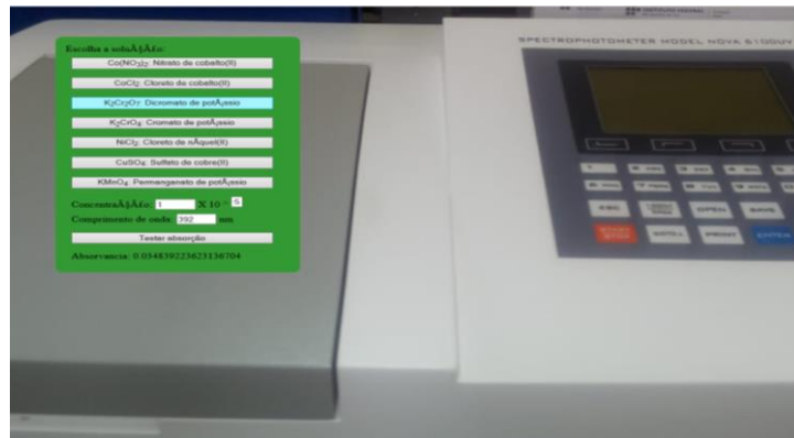
Figura 11: Interface do experimento virtual para a obtenção da absorbância para mesma substância, concentração molar e comprimento de onda.
