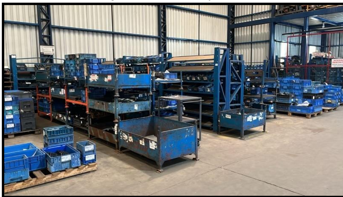
Figura 5 - Falta de demarcações claras
