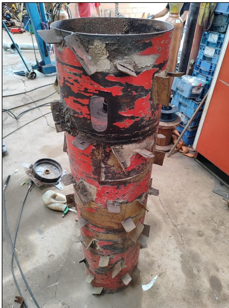
Figura 17 – Rolo fresador em etapa de manutenção.
