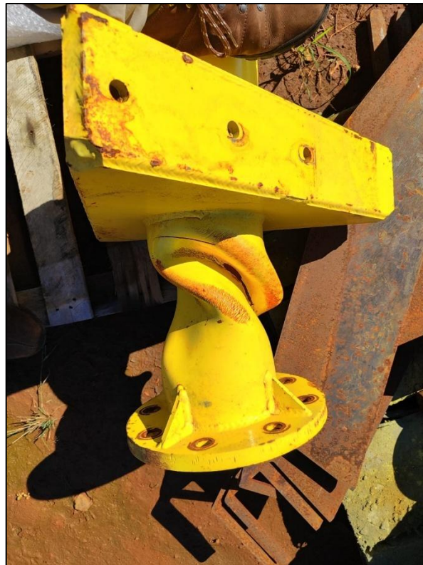
Figura 14 – Elemento rotativo da carreta forrageira com danos aparentes.
