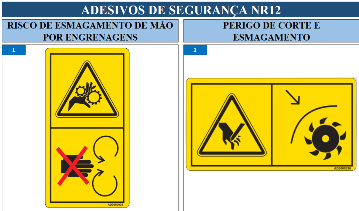
Figura 22 – Adesivo (1) Risco de esmagamento e (2) Perigo de corte e esmagamento.
