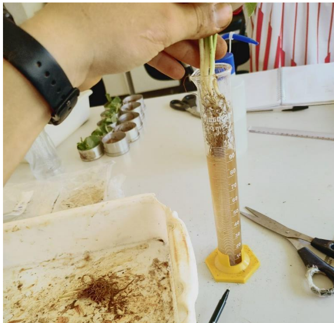
Figura 5: Quantificação de volume, através do método de deslocamento de fluidos no laboratório de sementes Campus Ibirubá
