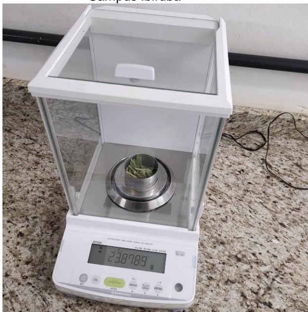
Figura 4: Pesagem da massa seca com o uso de balança de precisão no laboratório de sementes Campus Ibirubá
