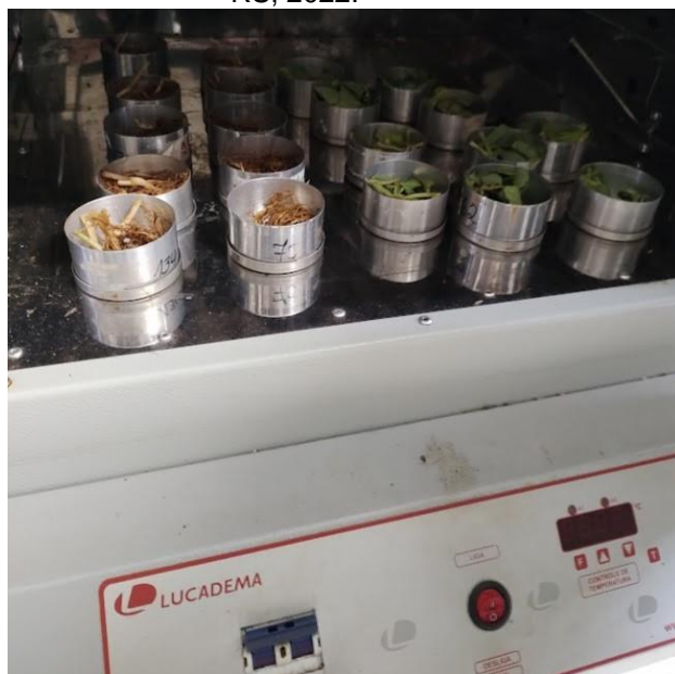
Figura 3: Amostras para determinação da massa seca em estufa de circulação de ar forçada. Ibirubá RS, 2022.
