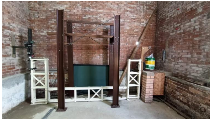
Figura 9: Aparato construído para verificação da rigidez da estrutura (Fonte: Dados próprios)
