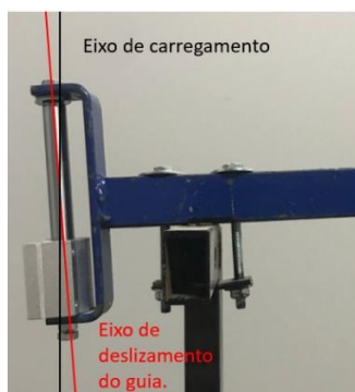
a) Não colinearidade do eixo de deslizamento do guia.
