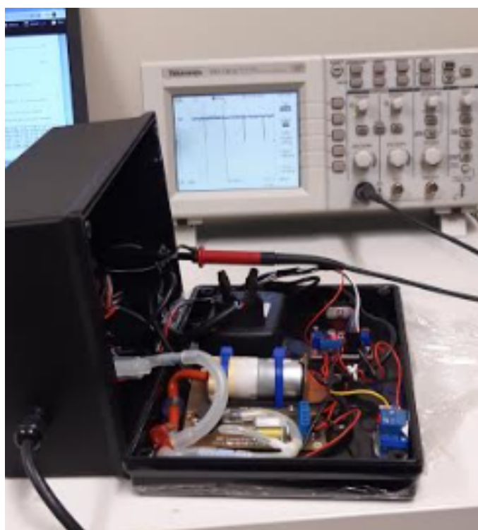
Figura 27 – Medição da frequência gerada usando um osciloscópio digital.
