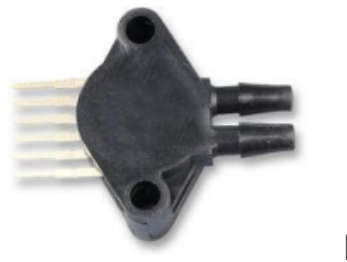
Figura 14 – Sensor de pressão diferencial MPX5700DP, foi aplicado devido ser um componente de fácil aplicação e comunicação.
