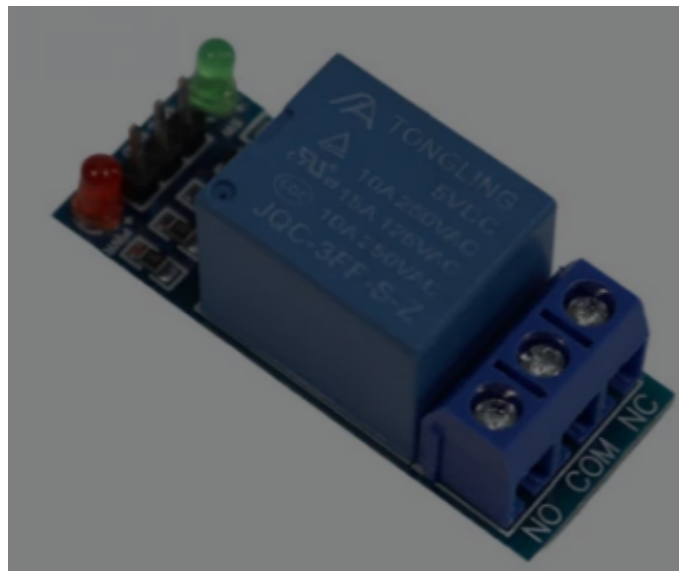
Figura 16 – Módulo relé 5V, com NA e NF.
