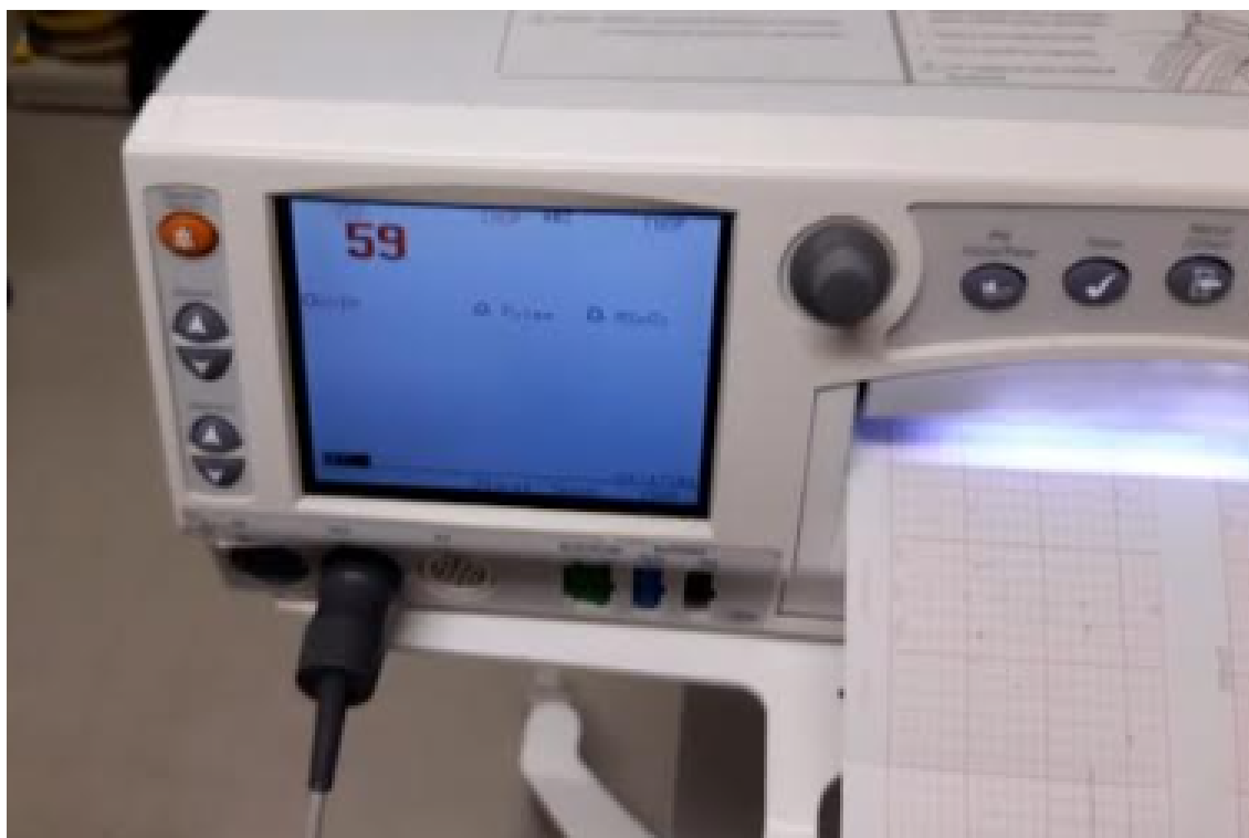
Figura 30 – No canto superior esquerdo é ilustrado o valor do batimento que o monitor materno fetal esta recebendo do simulador materno fetal.
