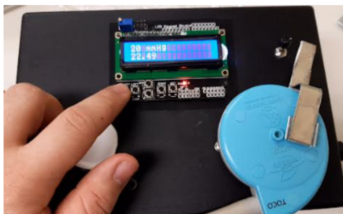
Figura 32 – Configurando o simulador materno fetal para gerar 20 mmHg.
