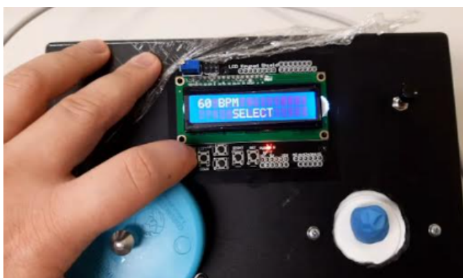
Figura 29 – Configuração do simulador materno fetal para a geração de 60 BPM.
