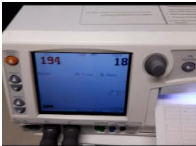
Figura 33 – Na lateral direita tens o valor da pressão uterina gerada pelo simulador materno fetal.
