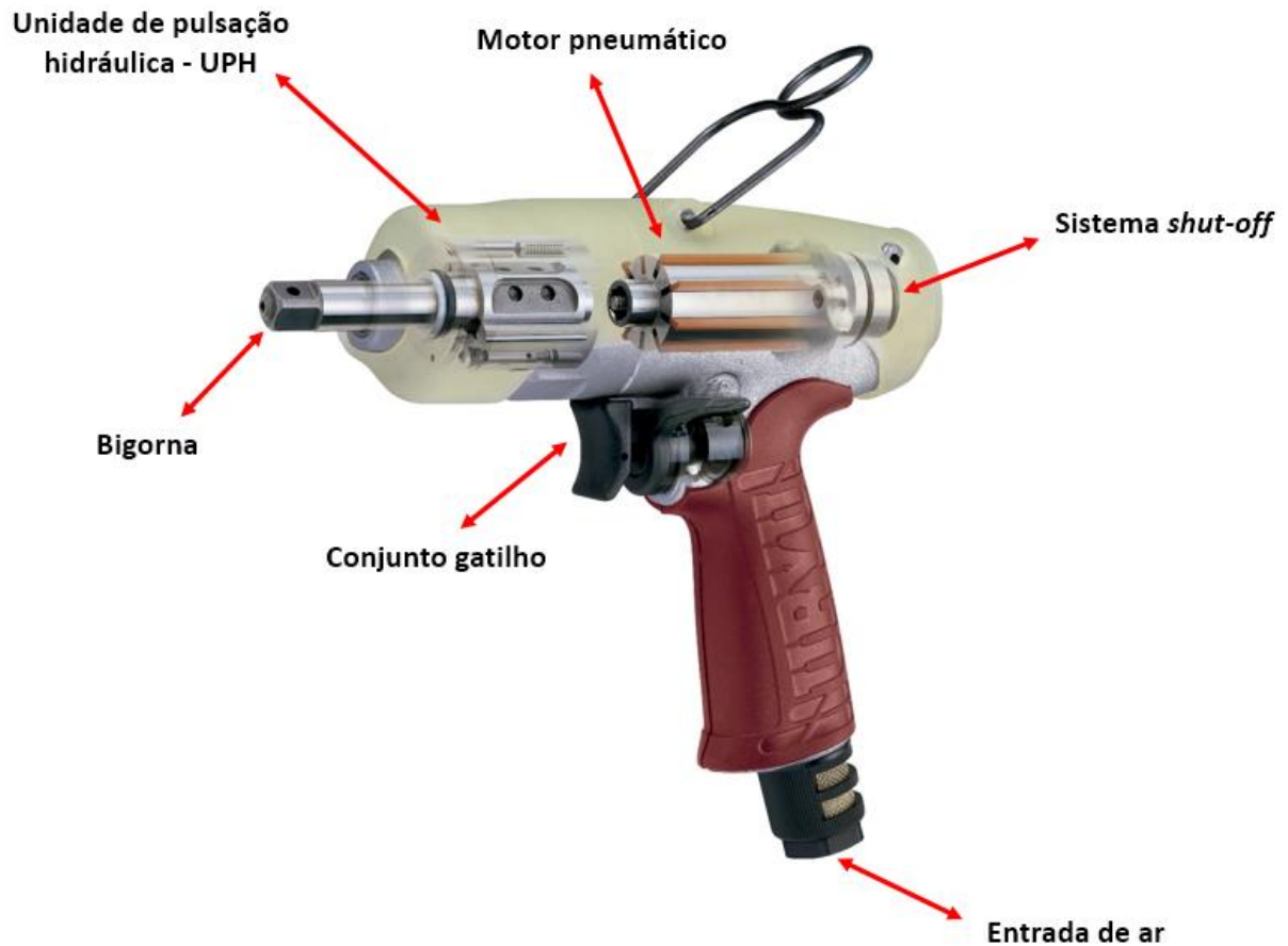
Figura 2 – Ilustração Chave Torque Hidro-pneumática
