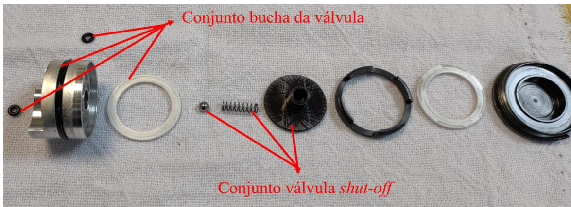
Figura 14 – Itens críticos Sistema Shut-off .
