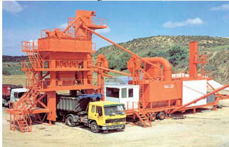
Figura 12 - Exemplo de uma usina asfáltica por batelada ou gravimétrica
