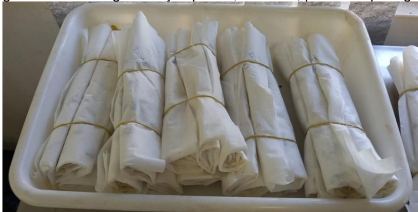
Figura 2. Teste de germinação pronto, em rolos, para ir para germinador.
