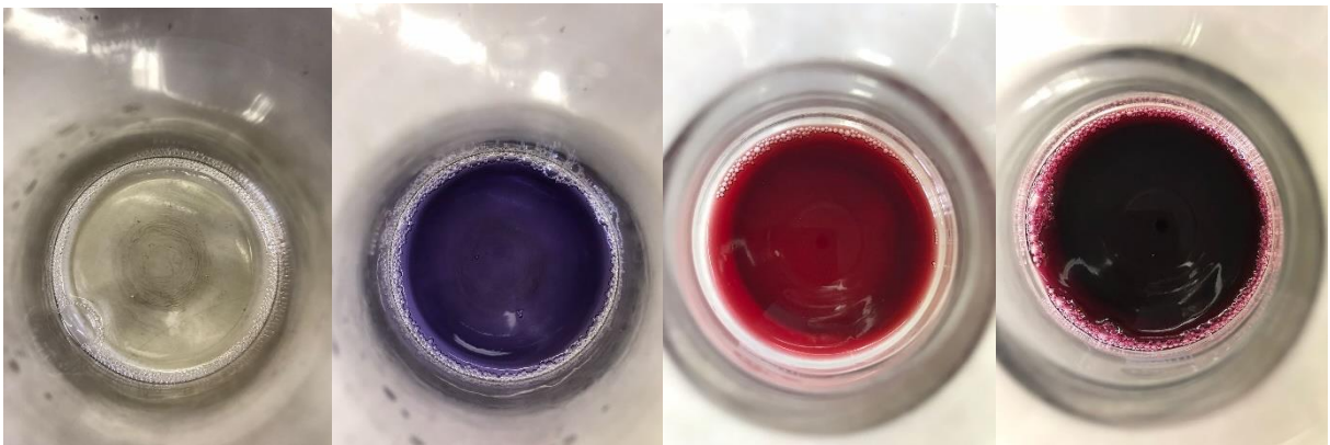
Figura 20 Determinação de SO 2 Livre e Total em branco e tinto
