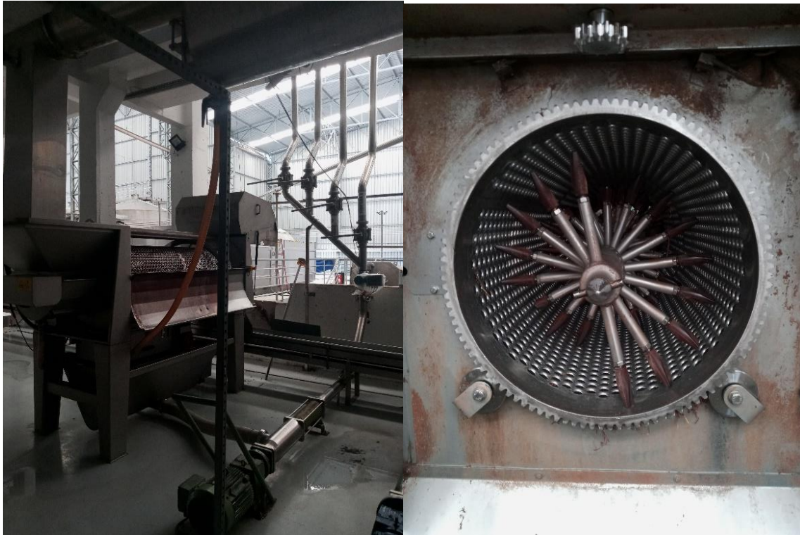
Figura 5 Desengaçadeira (vista externa e interna)
