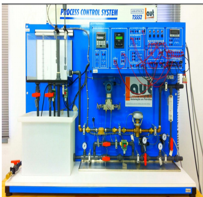
Fig. 4. Bancada de controle de nível e vazão [4]
