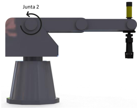
Figura 11: Vista lateral representativa do robô com torque atuante na junta 2.
