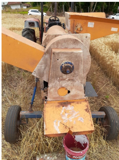
Figura 14: Trilhadora tratorizada utilizada para trilhar e limpar amostra de grãos.
