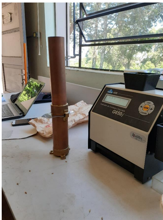
Figura 15: Equipamentos utilizados para determinação da massa da amostra e aferição da umidade.
