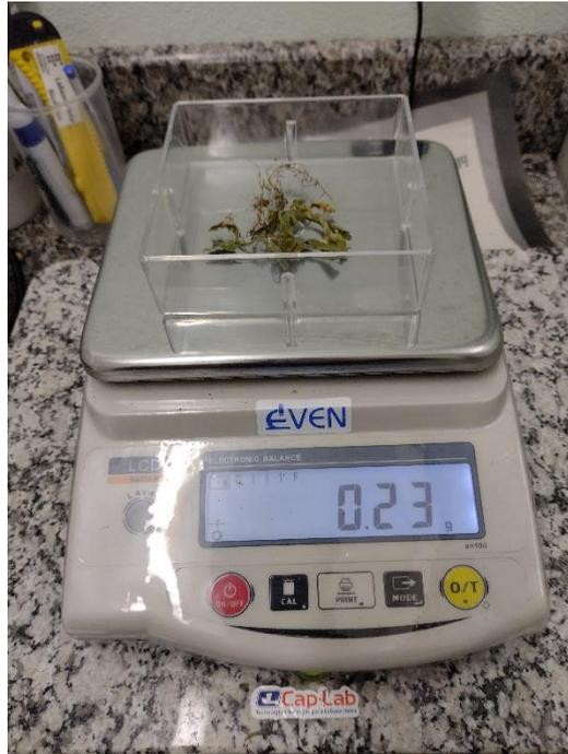
**Figura 22.** Pesagem das amostras de massa seca de *Conyza* spp. em balança eletrônica. IFRS Campus Ibirubá, 2022.
