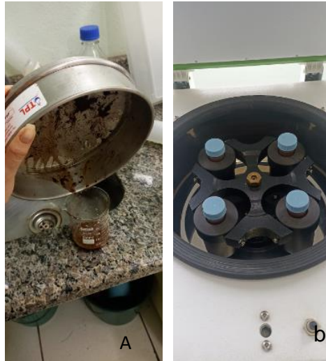
Figura 17: Solo escoado com auxílio de solução de sacarose (A) e posterior agitação em tubos de falcon (B).
