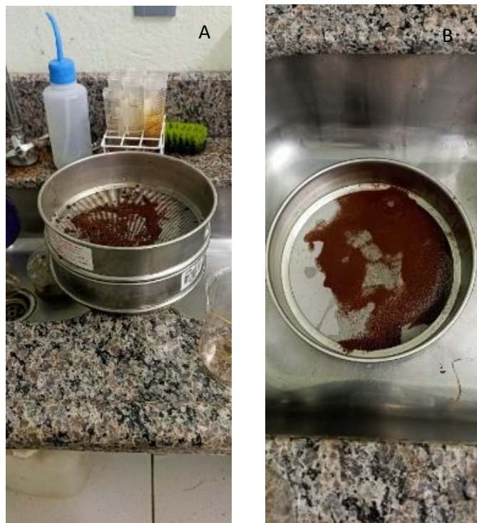
Figura 16: Solo peneirado em duas peneiras (A) com auxílio de água destilada (B) para análise da densidade de esporos.
