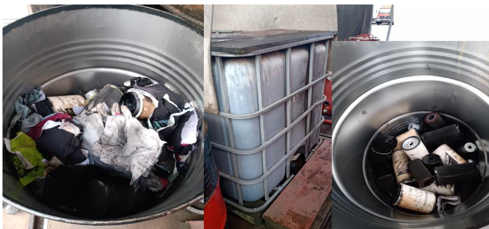
Figura 03- Descarte de filtros e estopas utilizadas na troca de óleo na transportadora
