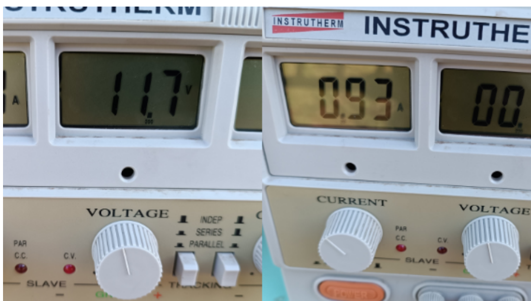
Figura 38 - Regulagem final da Fonte de Alimentação
