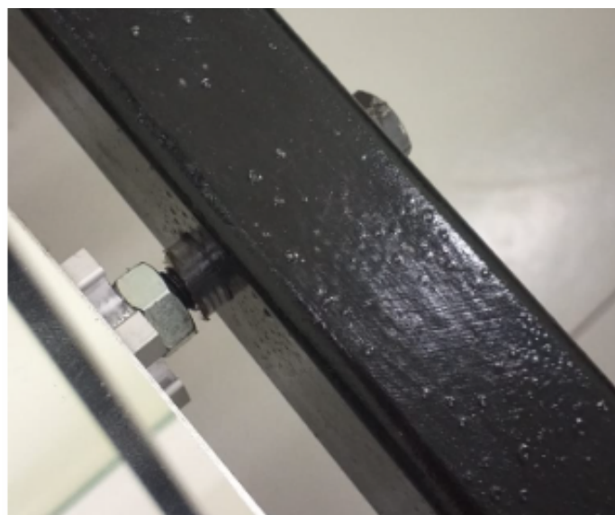
Figura 20 - Montagem das buchas no concentrador
