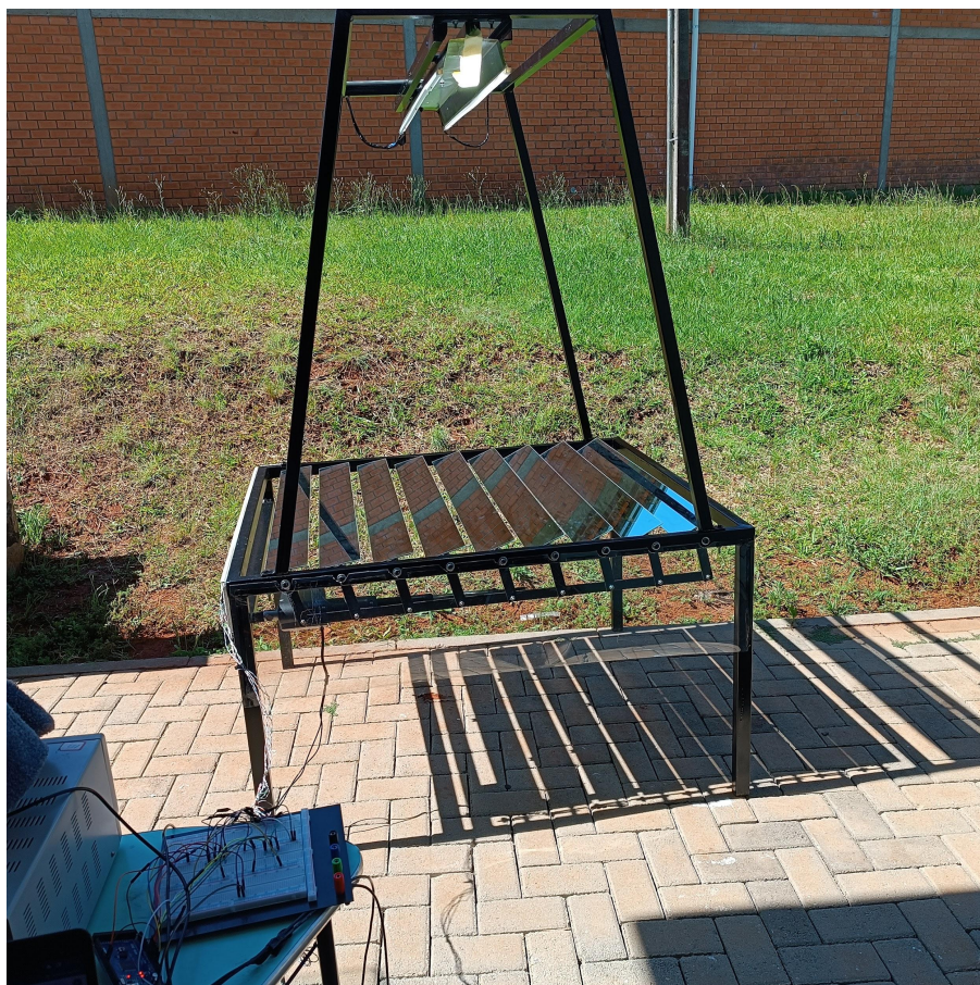
Figura 35 - Posição dos espelhos após a regulagem
