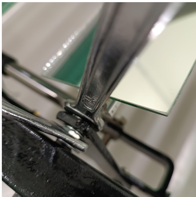
Figura 34 - Aperto e Alívio das porcas e contraporcas para regulagem
