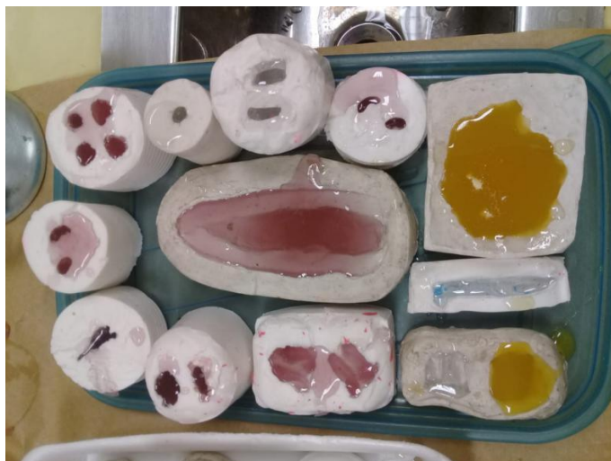
Figura 4: réplicas feitas de resina de poliéster em moldes de silicone.
