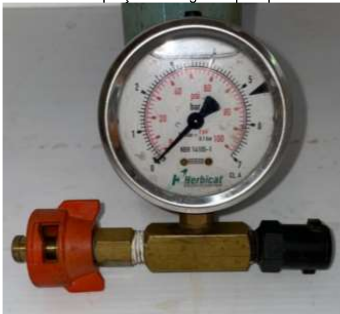
Figura 6 - Manômetro com adaptação de engate rápido para o bico de pulverização.
