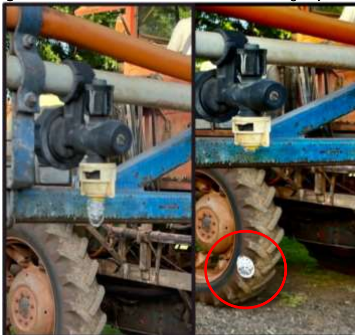
Figura 16 - Funcionamento incorreto dos antigotejadores.
