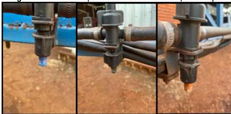
Figura 21 - Diferentes pontas na mesma barra de pulverização.
