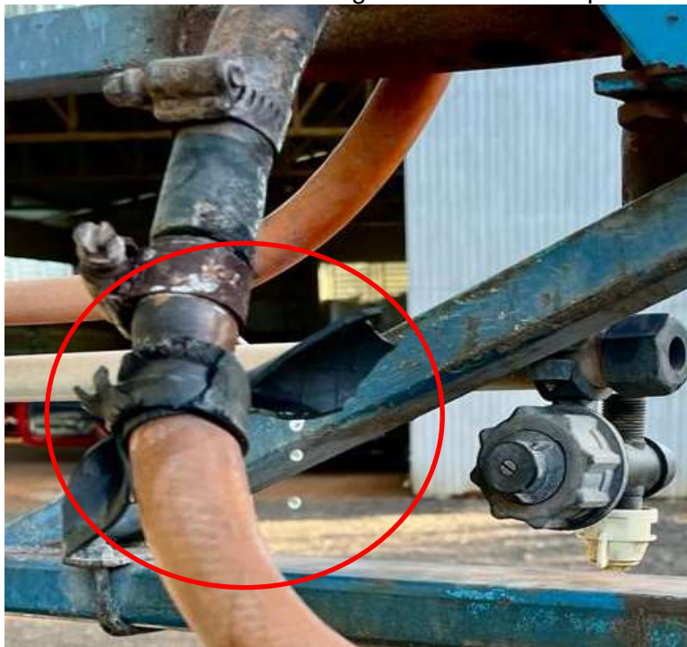
Figura 14 - Vazamentos nas mangueiras da barra de pulverização.
