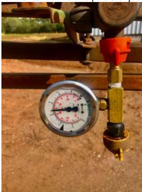
Figura 22 - Manômetro encaixado no bico para aferição de pressão.
