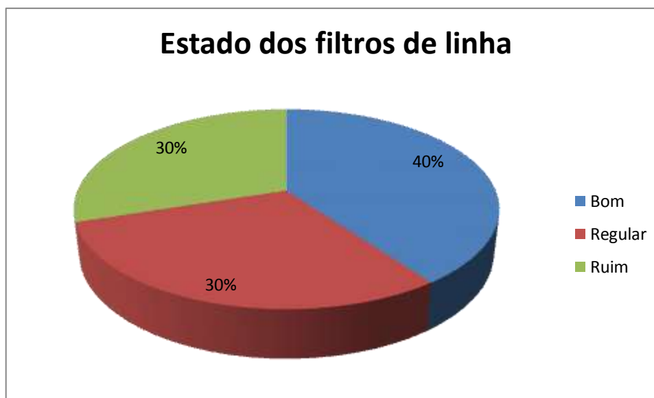
Figura 29 – Gráfico do estado de conservação dos filtros de linha dos pulverizadores.
