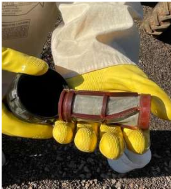
Figura 19 - Filtro de sessão retorcido e danificado.
