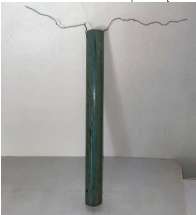
Figura 9 - Canos de PVC com arames para fixação nos bicos.
