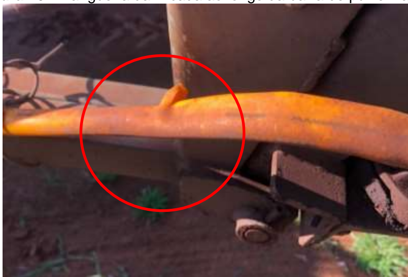
Figura 15 - Mangueira danificada ao longo da barra de pulverização.
