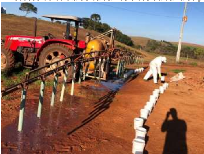
Figura 18 - Processo de coleta de calda nos bicos da barra de pulverização.
