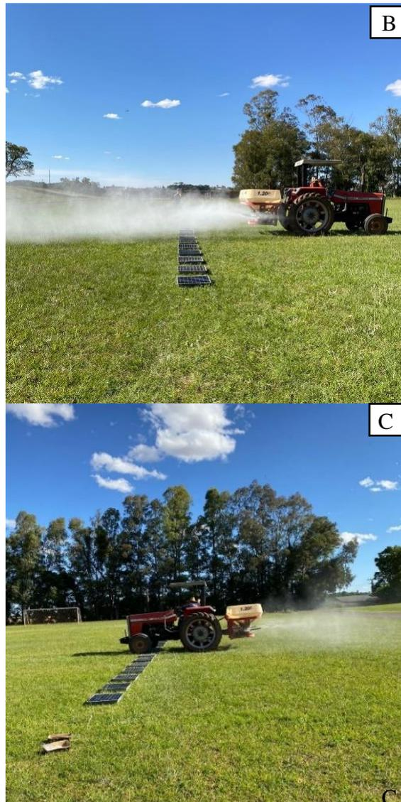
**Figura 7** – Distribuição do calcário seco (A), intermediário (B) e úmido (C).
