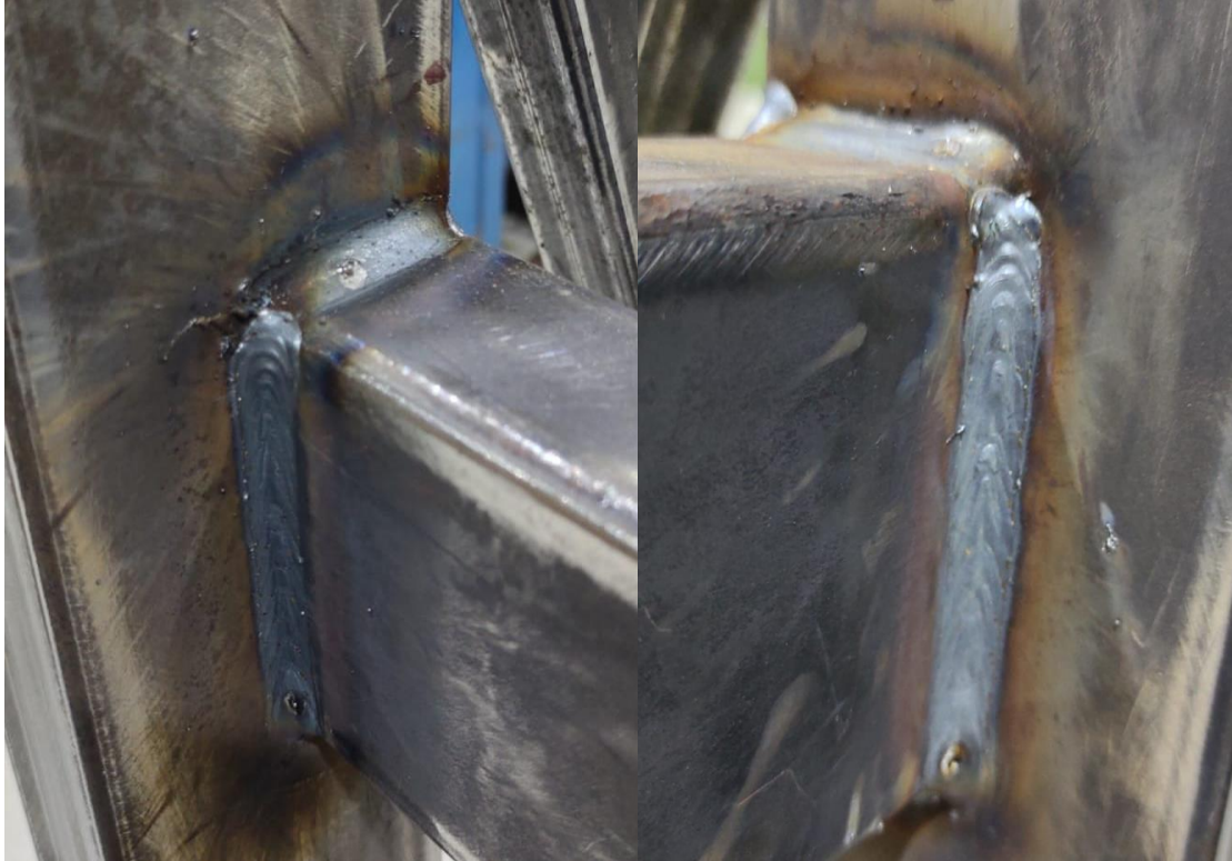
Figura 22: Solda executada na bancada de teste.
