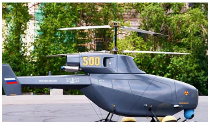
Figura 2: Exemplo de VANT de asa rotativa, helicóptero BVS VT 500 [14].
