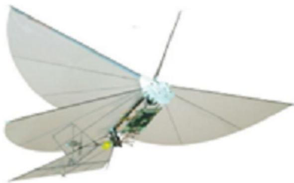
Figura 4: Exemplo de VANT Flapping-wing, Universidade da Califórnia (Berkeley) [12].
