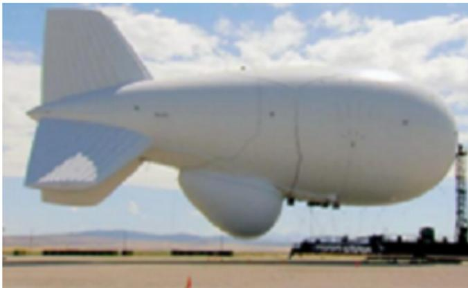
Figura 3: Exemplo de VANT Blimps, JLENS Raytheon Company[12].
