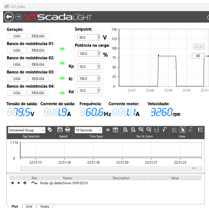
Figura 24 – Sistema supervisorio software VTScada
