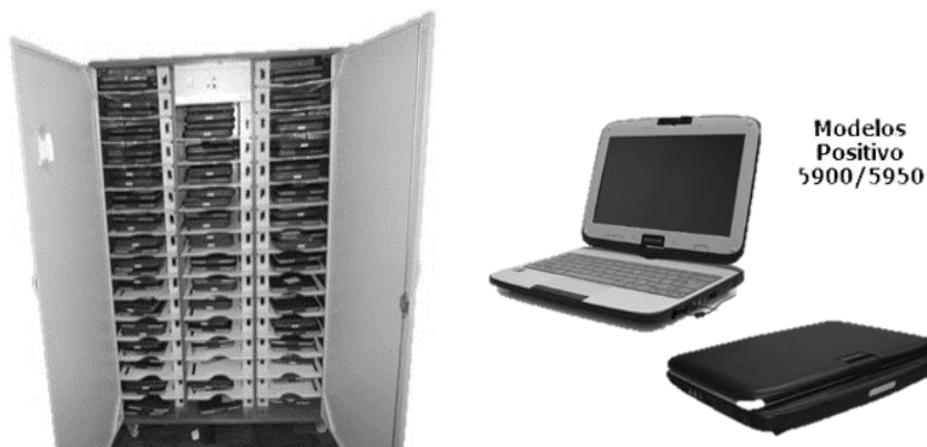
Figura 18 - Armário para armazenamento e carga dos laptops e modelo MOBO 5900/5950 do Laboratório Móvel.
