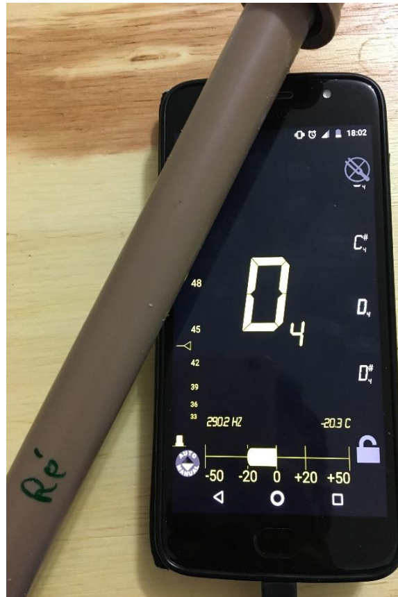
Figura 21: Captação da nota Ré em tubos fechados. Fonte: Do autor
