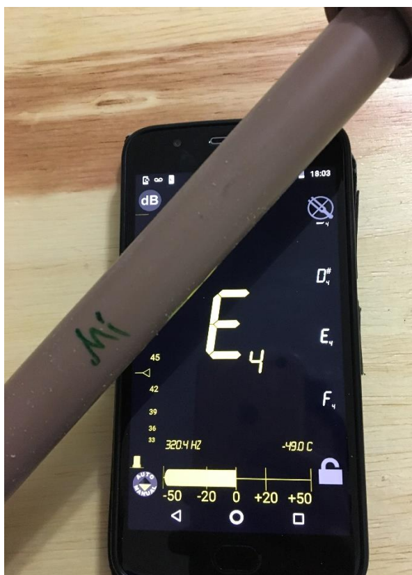
Figura 22: Captação da nota Mí em tubos fechados.
