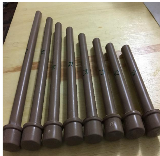
Figura 9: Tubos sonoros fechados em uma extremidade.
