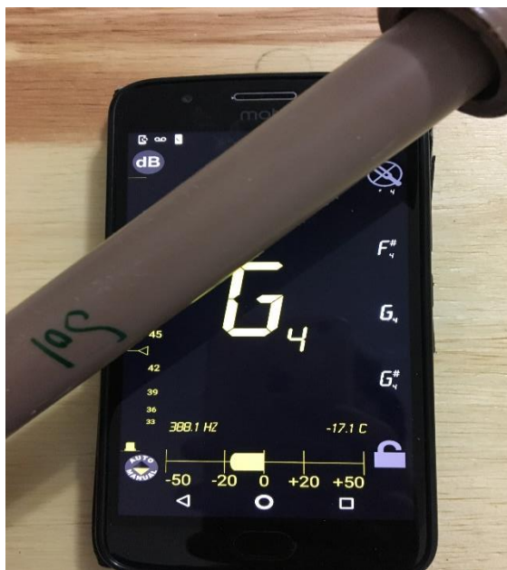
Figura 24: Captação da nota Sol em tubos fechados.
