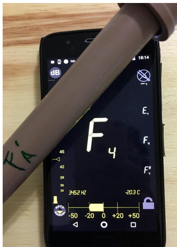
Figura 23: Captação da nota Fá em tubos fechados.
