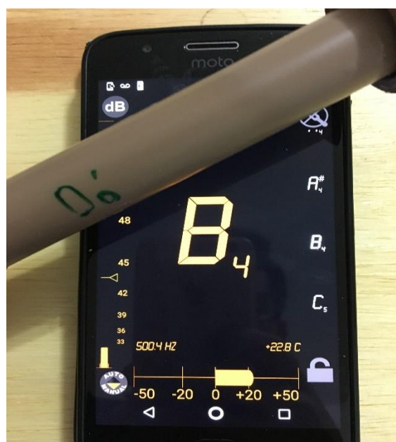
Figura 27: Captação da nota Sí em tubos fechados.
