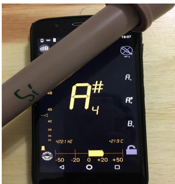
Figura 26: Captação da nota Lá sustenido em tubos fechados.
