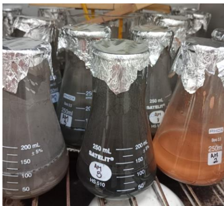
Figura 13 – Amostras de Cimento acondicionadas na estufa à 40°C
