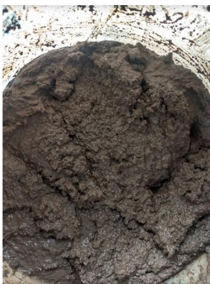
Figura 9 - Preparo da Argamassa: insumos misturados na argamassa de referência
