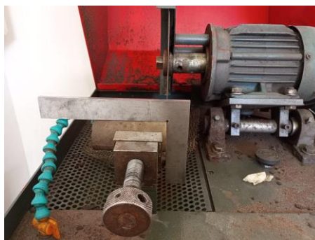
Figura 16 - Retificação do topo e base dos corpos de prova
