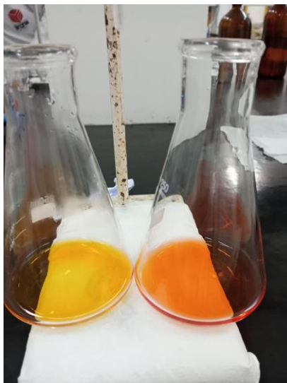
Figura 14 – Ensaio de titulação de álcalis livres: amostras antes e após o ponto de viragem
