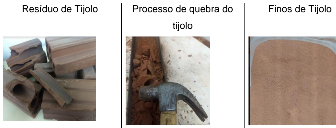
Figura 5 - Preparo do tijolo utilizado na formulação de argamassa
