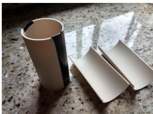
Figura 8 - Construção do molde para corpo de prova cilíndrico
