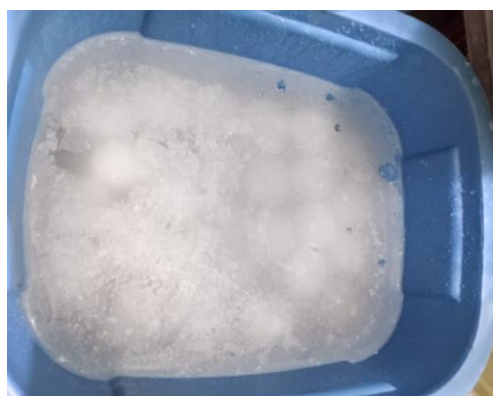
Figura 11 - Cura úmida dos corpos de prova com cal.
