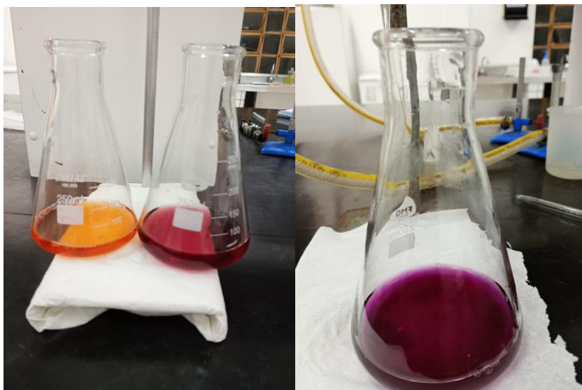
Figura 15 – Ensaio de titulação de determinação de CaO: amostras com ajuste de pH, adição de murexida e após o ponto de viragem
