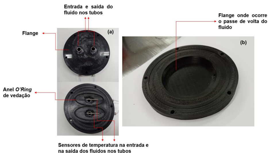
Figura 17 – Flanges confeccionadas na impressora 3D.
