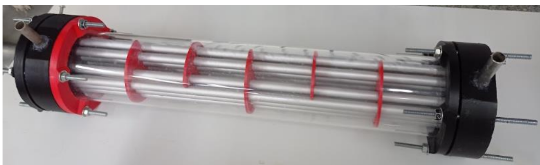
Figura 21 – Protótipo do trocador de calor casco tubos com duas passagens nos tubos.
