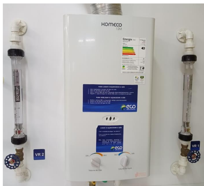
Figura 6 – Rotômetros e aquecedor utilizados.
