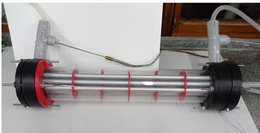
Figura 23 – Protótipo com as mangueiras e sensores conectados.
