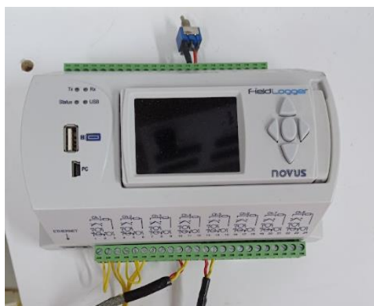
Figura 7 – Registrador de dados e controlador programável utilizado.
