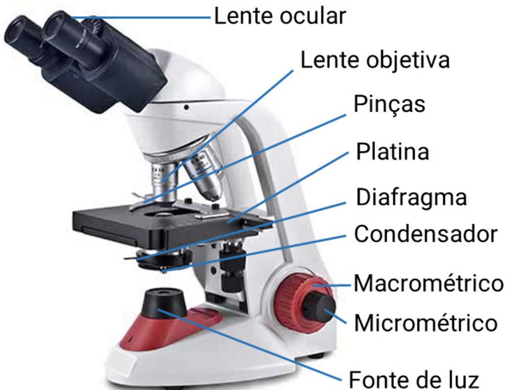
Estrutura do microscópio óptico. Fonte: adaptado de: <https://kasvi.com.br/>
