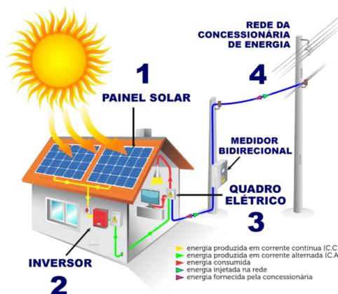
Figura 1: Sistema de Geração Fotovoltaico Residencial (ENGNOVAR, 2021).
