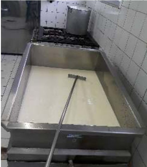
Imagem 15 - Tanque de coalhagem do leite e corte da massa
