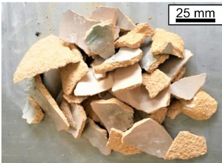
Figura 6: Resíduo da casca cerâmica do processo de fundição de precisão (RCCF) em lascas.
