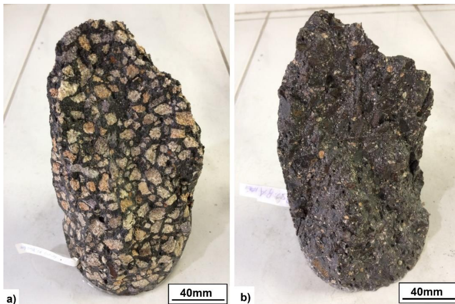
Figura 33: Concreto rompido após 28 dias de cura. (a) CP com 100 % de RCCF – brita em substituição da brita. (b) CP com 100 % de RCCF-areia em substituição da areia.
