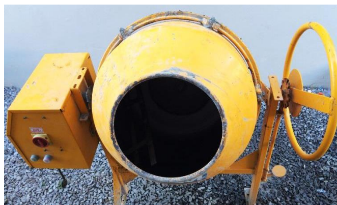
Figura 11: Betoneira usada para misturar componentes do concreto.
