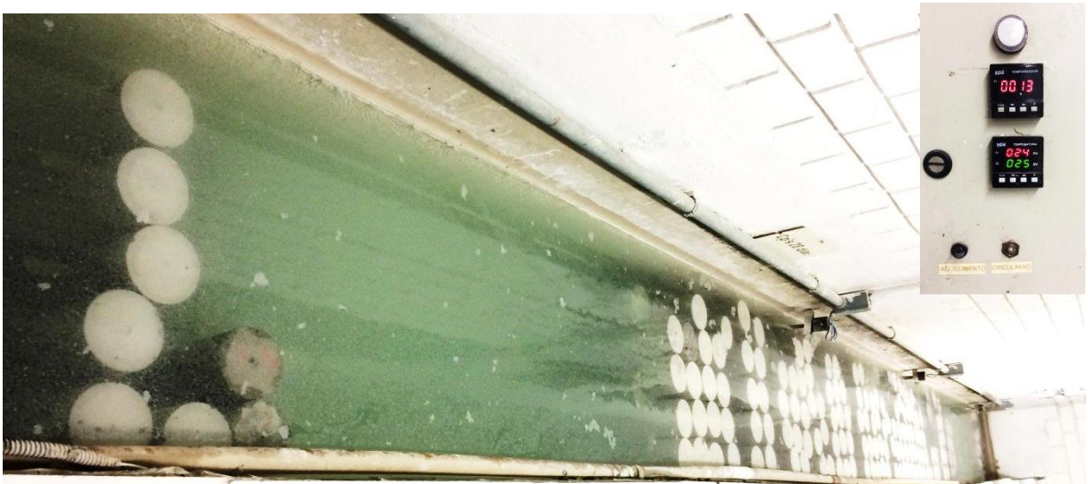
Figura 14: CPs imersos em solução saturada de hidróxido de cálcio.
