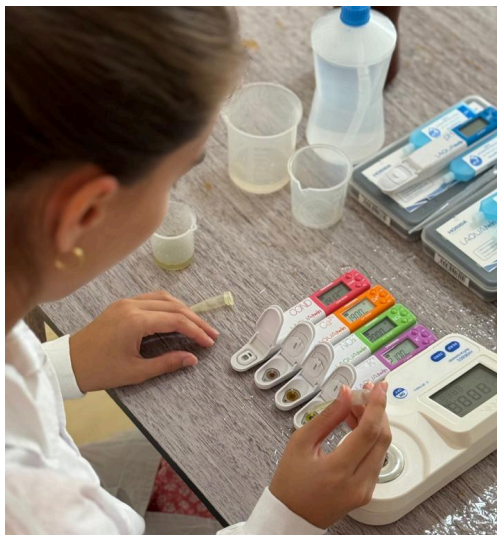
Figura 8: Colocando uma gota de extrato de pecíolo com micropipeta sobre o eletrodo do equipamento.
