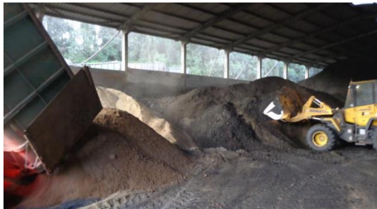
Figura 3: Descarga e homogeneização dos resíduos
