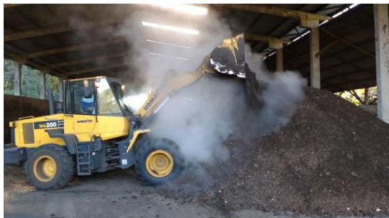
Figura 4: Montagem da leira
