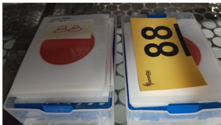
Figura 13 - Placas Petrifilm CT para incubação a 44 \pm 1 °C por 24 \pm 2 horas
