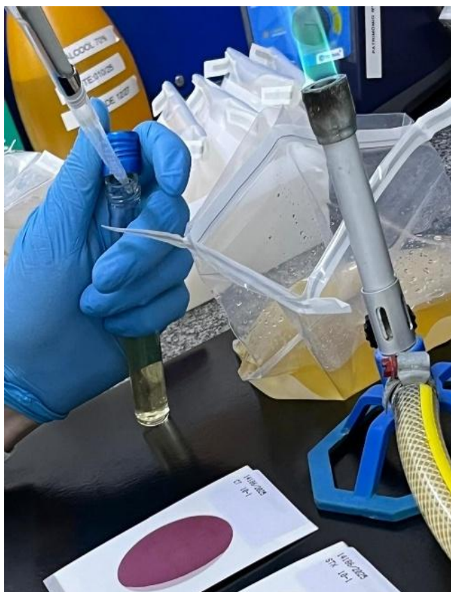
Figura 11 - Etapa de preparo das placas Petrifilm CT para análise de coliformes
