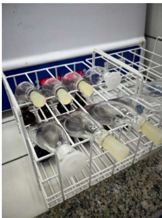
Figura 7 - Amostras em repouso na extração de lipídios por método Mojonnier
