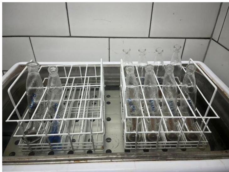
Figura 6 - Frascos tipo Mojonnier em banho-maria durante a etapa de extração
