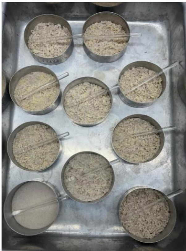
Figura 5 - Cápsulas de alumínio contendo amostras de queijo e areia
