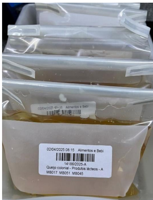
Figura 9 - Suspensão de amostra de queijo colonial em diluente APT
