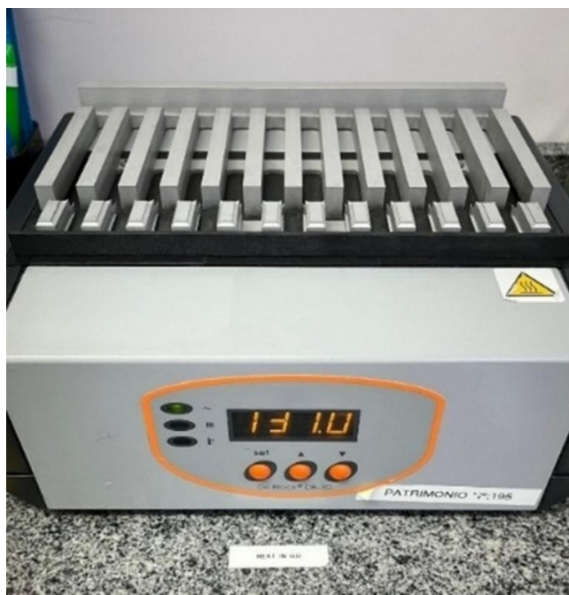
Figura 25 - Equipamento Heat-and-go utilizado para o aquecimento do barrete
