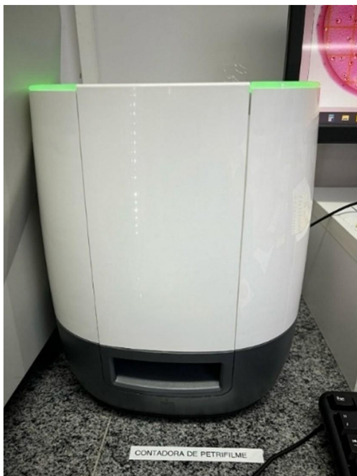
Figura 14 - Equipamento Petrifilm Plate Reader Advanced utilizado para leitura
