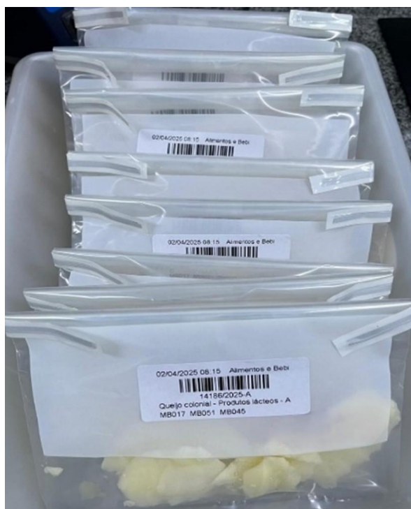
Figura 8 – Amostras pesadas em sacos estéreis para análises microbiológicas
