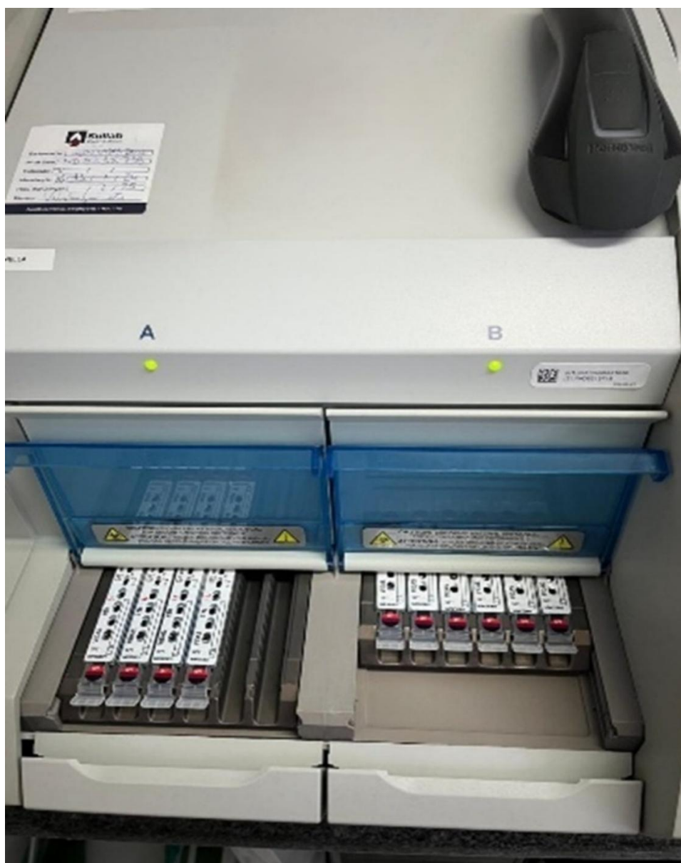
Figura 27 - Equipamento com cartuchos para detecção de Salmonella spp.
