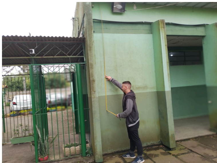
Figura 48 – Medindo a altura do prédio da diretoria com trena em duas etapas.
