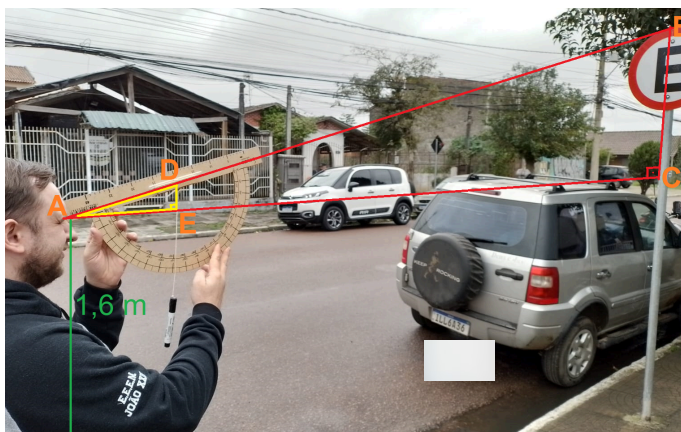
Figura 10 – Exemplificação de como observar um ponto de vista no transferidor.
