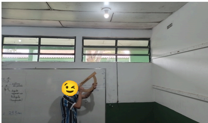
Figura 14 – Medição do ângulo para estimar a altura da sala com trigonometria.
