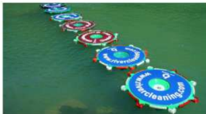
Imagem 3 - River Cleaning System (dispositivo flutuante movido pela correnteza). Fonte:
