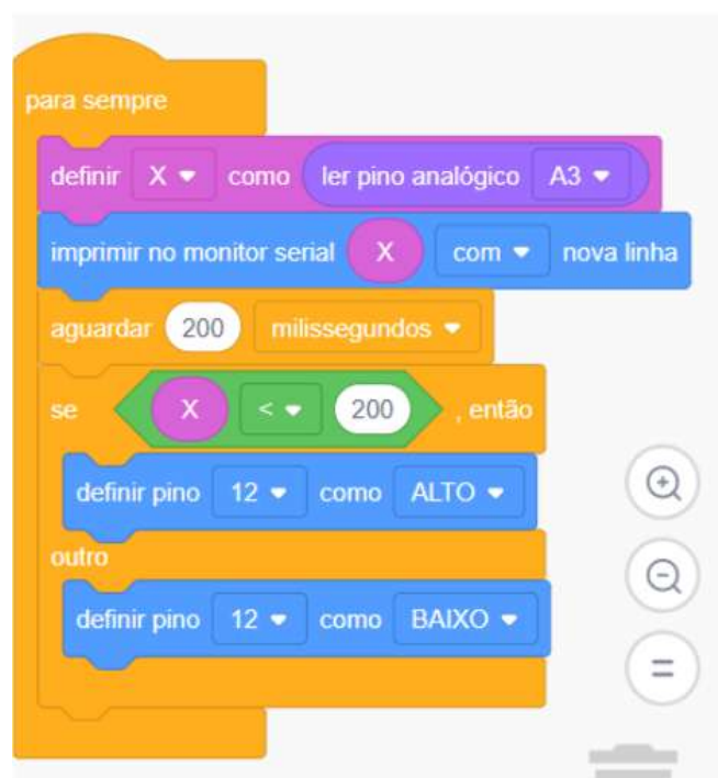
Figura 2. Bloco de programação utilizado para controlar uma saída digital através da leitura de um sensor de umidade do solo. Fonte: o autor.
